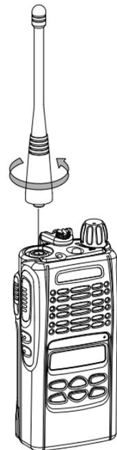
1. Allineare la terminazione filettata dell'antenna con il connettore dell'antenna della radio.
